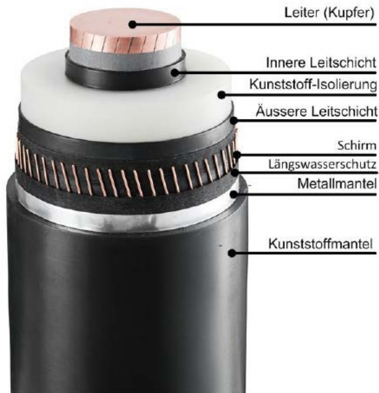
Abbildung 3: Querschnitt eines VPE-Kabels
