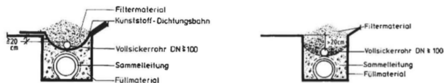
Abbildung 14: Entwässerungseinrichtung, Sammelleitungen (Quelle: RAS-Ew)
