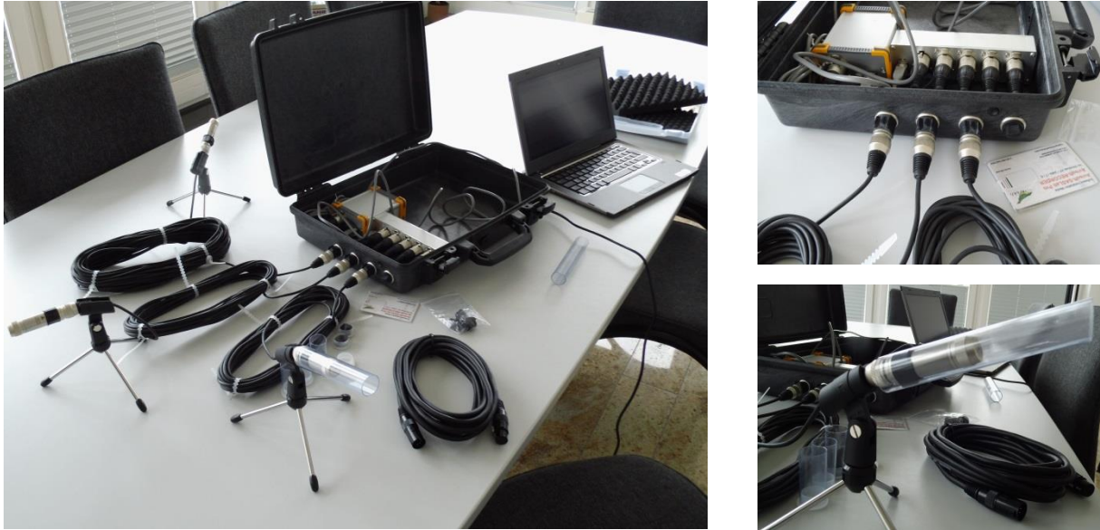
Abb. 3: Fledermaus-Erfassungssystem mit Mikrofon-Schutzhülle (unten rechts)
