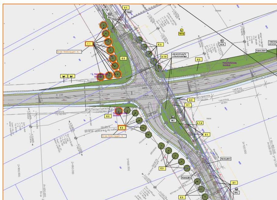
Abb. 4: Beispiel der Lage von Ausgleichs- und Ersatzpflanzungen, hier an der Kreisstraße MSE 20 nach Knotenpunktausbau (Ersatzmaßnahme E3); (Quelle: Plananschnitt Lageplan Maßnahmen trassennah, Unterlage 12.2.1)
