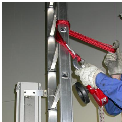
Bild 7 11: Befestigen Sie die Abseilausrüstung am Holm der Leiter.
