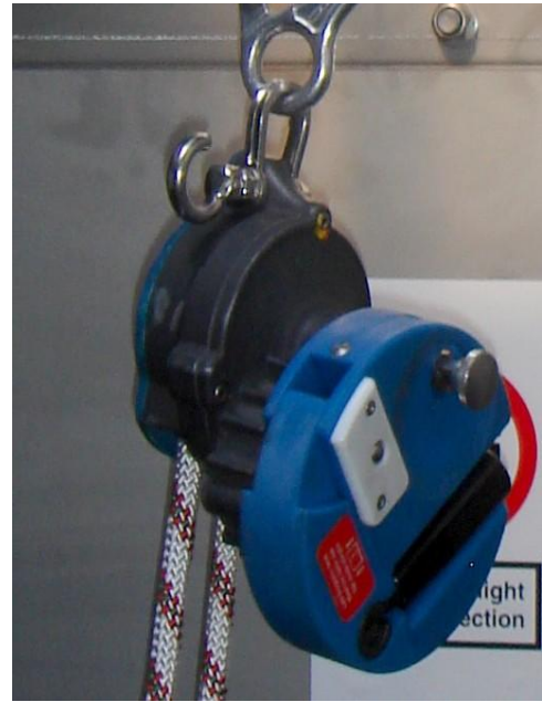
Bild 7 10: Drehen Sie das Rad, um den Verletzten anzuheben.
