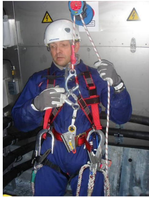
Bild 7 4: Befestigen Sie die Abseilausrüstung für Notfälle an den D-Ringen an der Vorderseite des Sicherheitsgeschirrs, und ziehen Sie zum Straffen am Seil.
