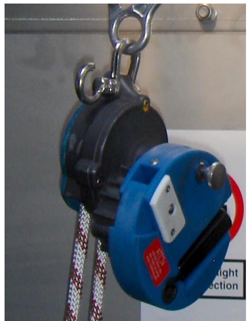
Bild 7 6: Mithilfe des Rads können Sie sich nach oben ziehen.
