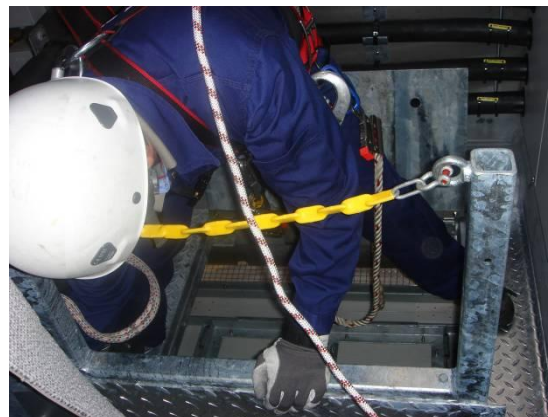
Bild 7 8: Öffnen Sie die Notausstiegsluken in der Gondel.
