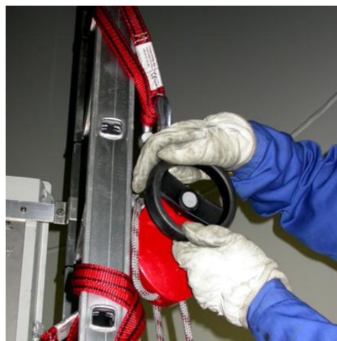
Bild 7 14: Drehen Sie das Rad, um den Verletzten anzuheben.
