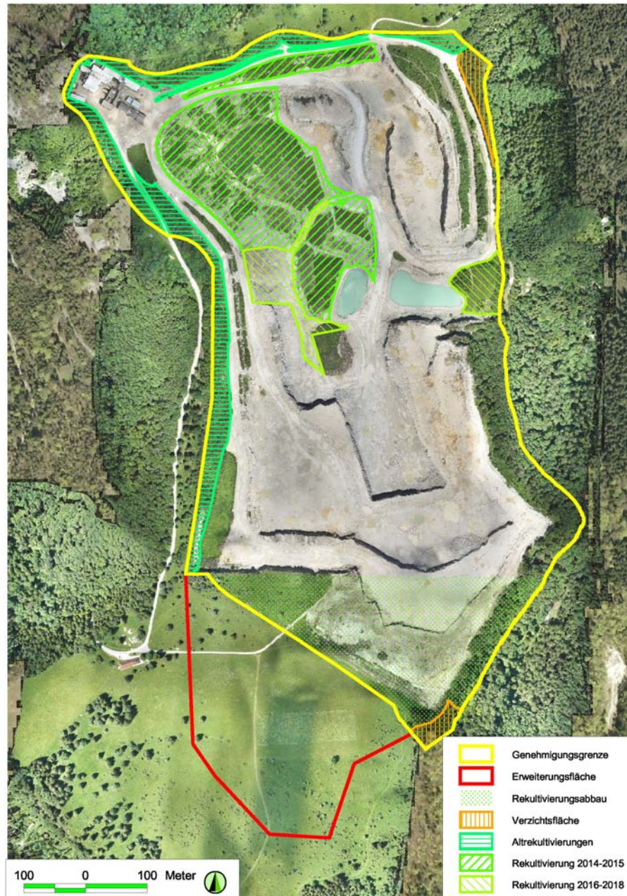
Abb. 1: Übersicht über den genehmigten Steinbruch, die beantragte Erweiterungsfläche, die Rekultivierungsflächen und die Flächen zum Abbauverzicht. Rekultivierungsabbau: Abbau in Vorbereitung der genehmigten Rekultivierung entsprechend Genehmigungsentscheidung vom 02.02.1982.
