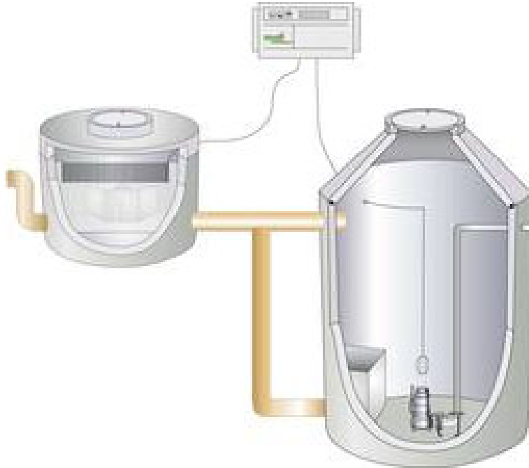
Grafik 1: Prinzipskizze Schmutzfangzelle, © Mall GmbH
