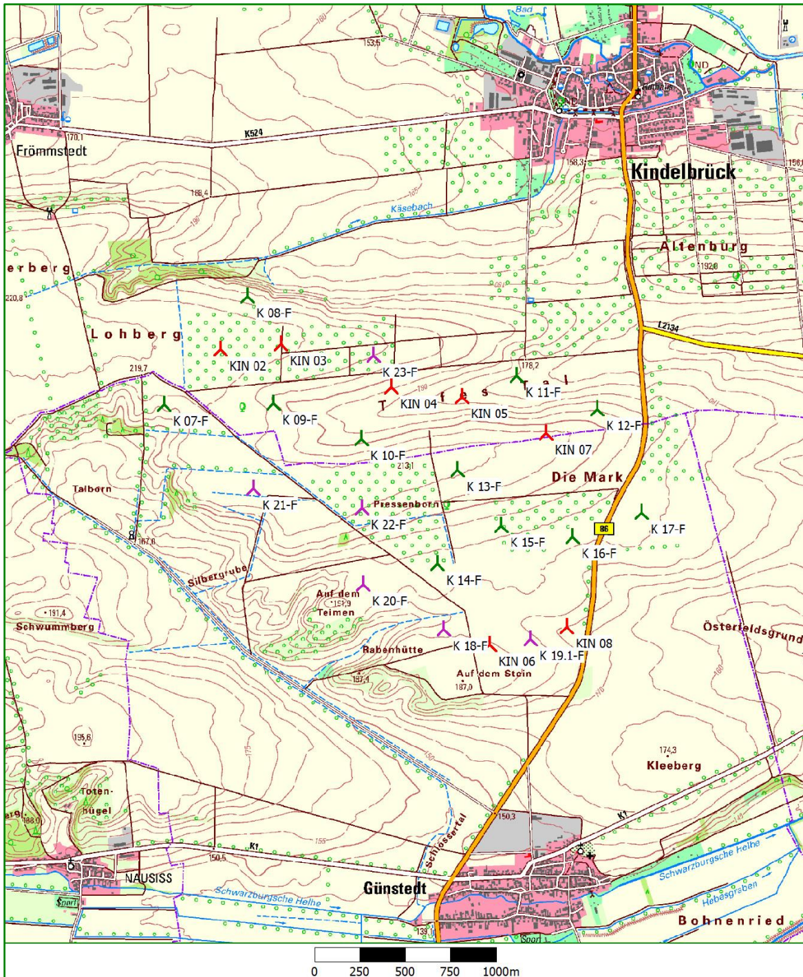
Lageplan (Maßstab ca. 1 : 30.000) mit Positionen der genehmigten WEA (grüne Symbole), der beantragten WEA (violette Symbole) und der geplanten WEA (rote Symbole)
