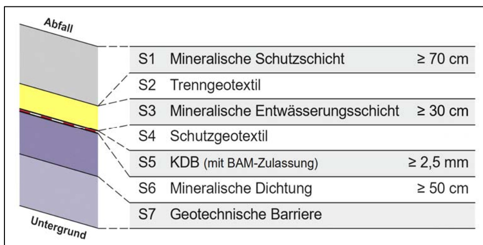
Abbildung 1: Aufbau der Basisabdichtung, vgl. [U 3]
