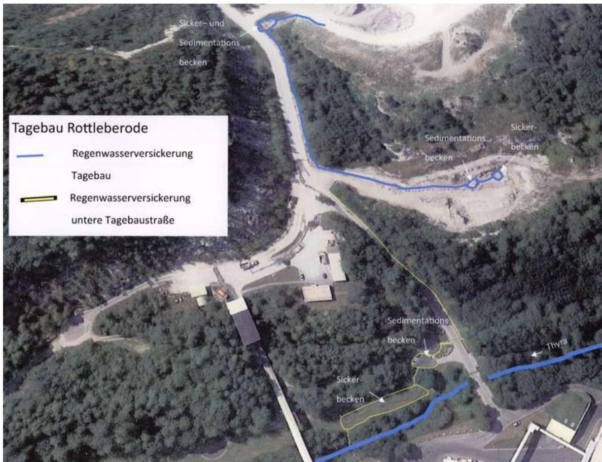
**Abbildung 22: Räumliche Anordnung der bestehenden Versickerungsanlagen (Stand 2016) im Tagebaubereich Rottleberode (entnommen aus [2])**
