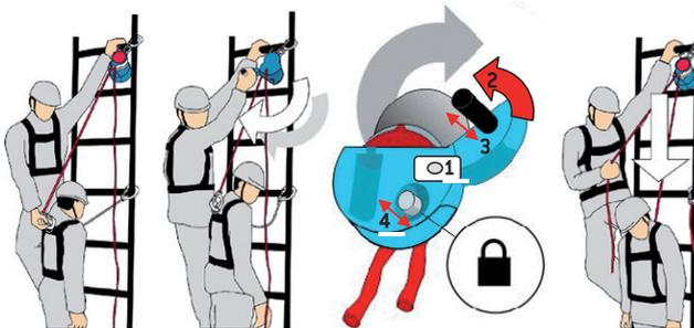
3. Das Rückholseil durch das Gerät ziehen, bis es zwischen der zu rettenden Person und dem Gerät voll gespannt ist. Wenn jetzt das Handrad geöffnet und im Uhrzeigersinn gedreht wird, kann die Person jetzt soweit angehoben werden, dass ihre Fallsicherung gelöst werden kann (vgl. Abb.).
