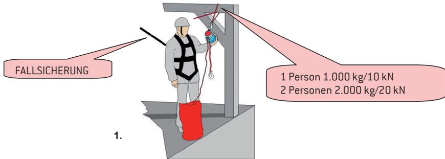
1. Die Ausrüstung an einem Punkt befestigen, der mit 1.000 kg (10 kN) belastet werden kann (vgl. EN 795). Er muss sich mindestens einen Meter über dem vorgesehenen Punkt des Herablassens befinden. Kontrollieren, dass der geplante Abstiegsweg frei von Hindernissen ist, die beim Absenken die freie Beweglichkeit einschränken könnten.
