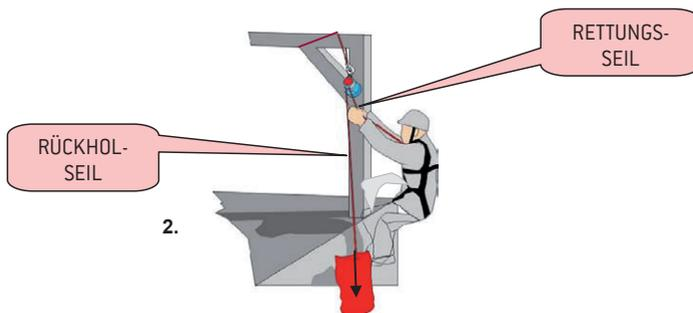
Das Rettungsseil ist am Befestigungspunkt an Brust oder Rücken des Gurts zu befestigen (siehe Anleitung für den Gurt). Dann am Rückholseil ziehen, um das Seil zwischen dem Gerät und dem Benutzer zu spannen. Die Knie beugen, bis Gurt und Seil das gesamte Gewicht tragen. Vorsichtig vom Gebäude schwingen und den Griff am Rückholseil lösen, um den Abstieg zu beginnen.
