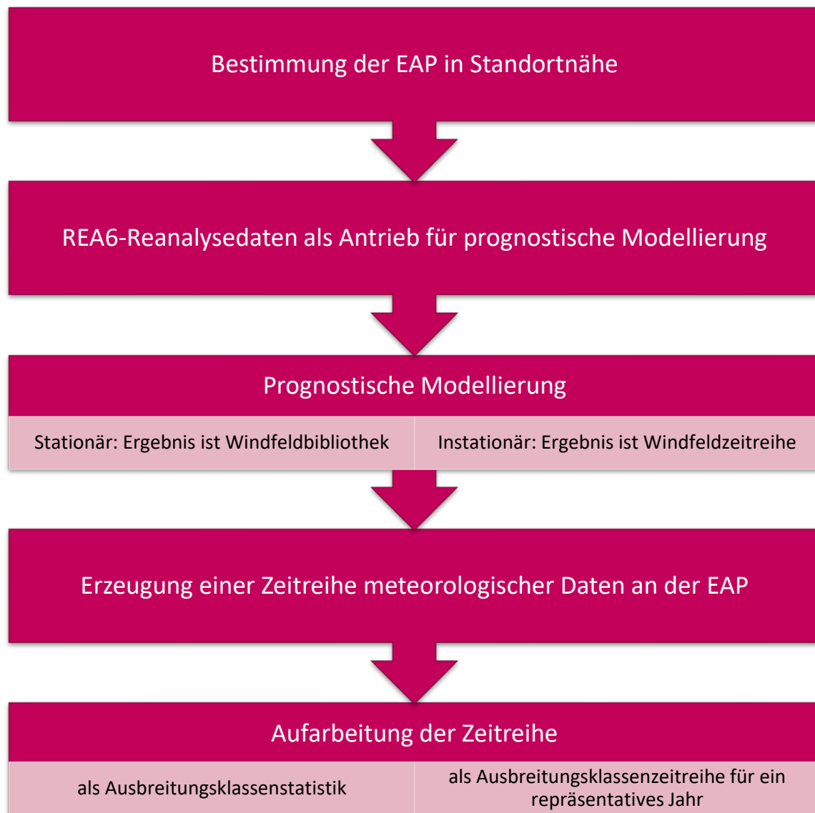
Abbildung 7: Sequenzieller Ablauf bei der Erzeugung modellierter Daten
