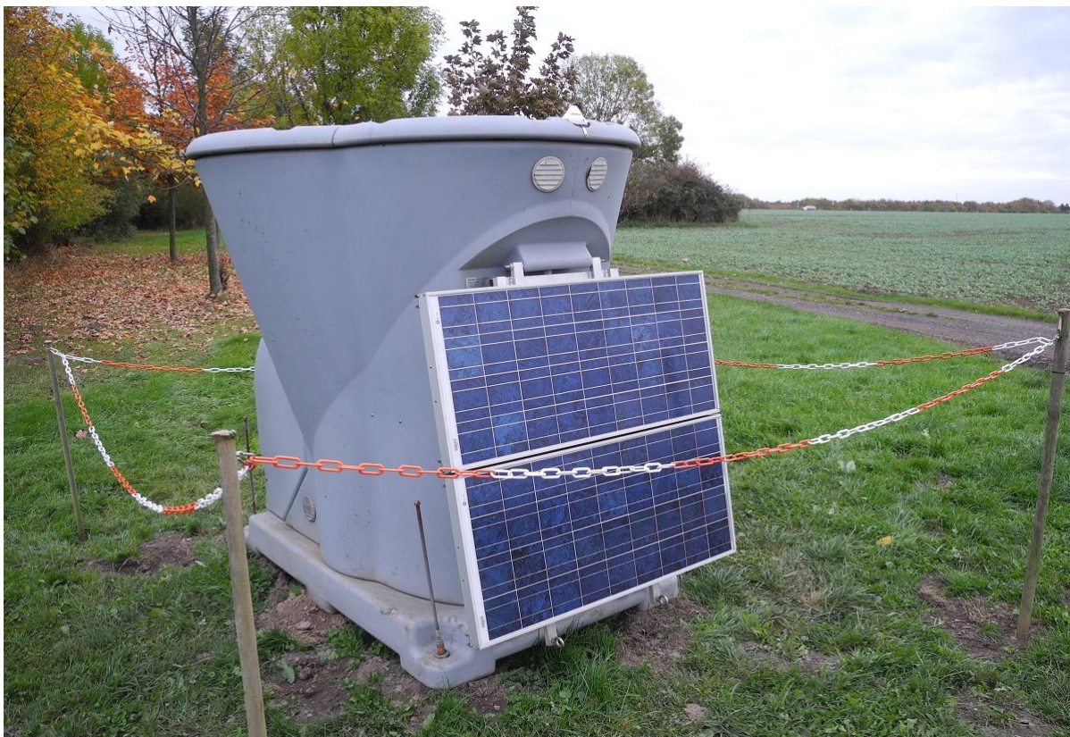
Foto 18: Akustische Apparatur zur Messung der Windhöffigkeit im Offenland nordwestl VF, Vergrämungseffekte durch andauernde weithin hörbare hochfrequente Töne sind nicht auszuschließen, 13.10.2017.
