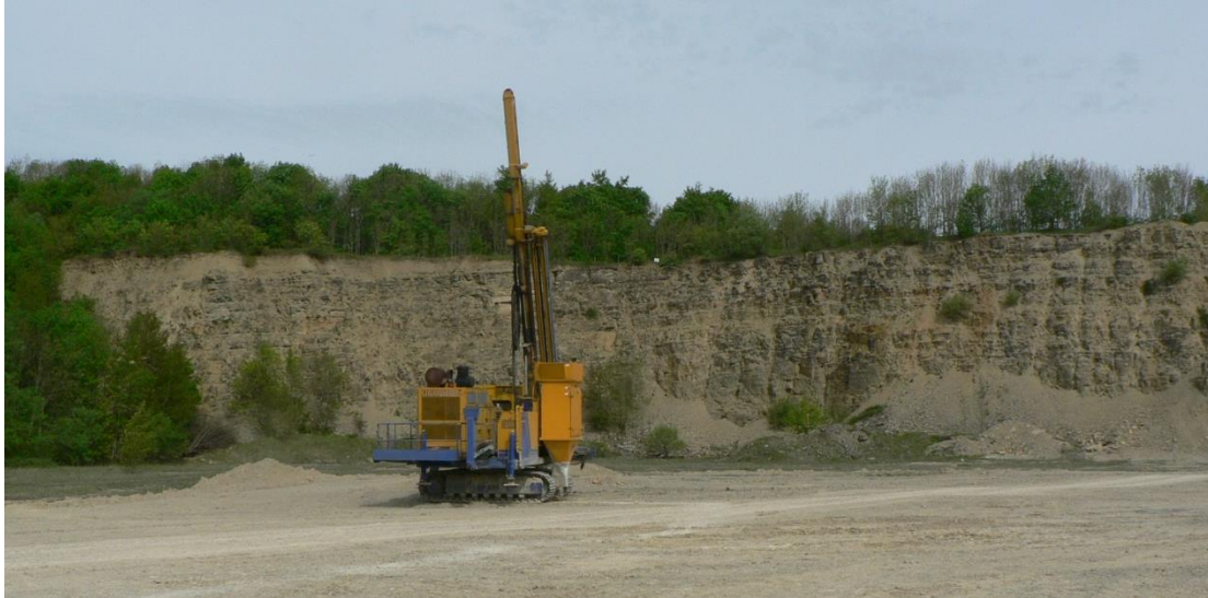
Abb. 5: Raupenbohrgerät HBM 120 für vertikale und vertikal geneigte Sprenglochbohrungen im Dreh- oder Tieflochhammerbohrverfahren
