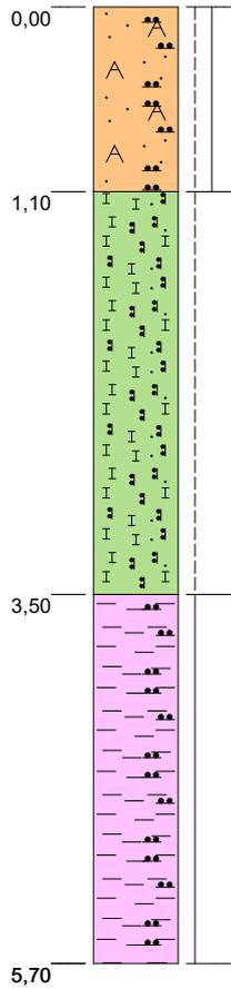
1,10; Auffüllung; Mischboden, Feinsand, schluffig, organisch, tonig, schwach kiesig, schwach feinsandig, dunkelbraun, steif bis halbfest, A (Auffüllung), TL (Ton, leicht plastisch)
