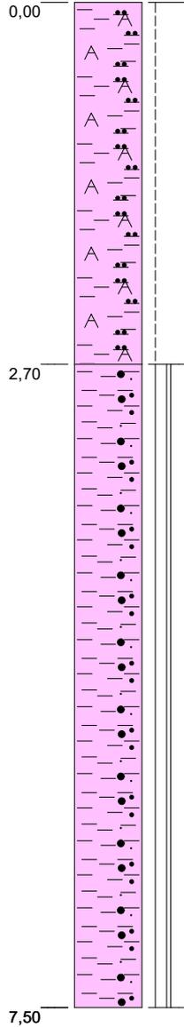
2,70; Auffüllung; Mischboden, Ton, schluffig, schwach sandig, schwach kiesig, schwach organisch, braun, steif, kalkhaltig, A (Auffüllung), TL (Ton, leicht plastisch)
