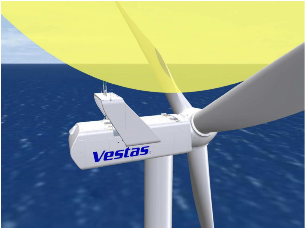
Abbildung 6.2: Blitzkugelberechnung für CoolerTop® (Version Mk 1)
