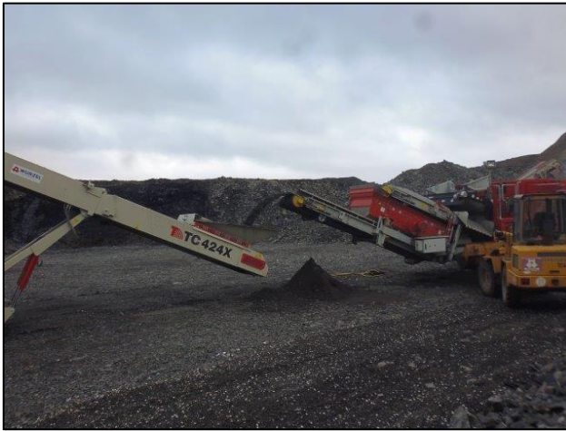
Abbildung 3: Abwurf Förderband beispielhaft
