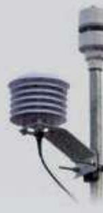
Die Wetterstation DOL 58 ermöglicht es, bei der Steuerung der Lüftung die Wetterbedingungen vor Ort mit einzubeziehen. Es werden die Windrichtung, die Luftgeschwindigkeit und der Luftdruck gemessen.
