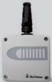
DOL 19 ist ein Sensor zur Messung des Kohlendioxidgehalts in der Stallluft. Die hochwertige Infrarot-Messzelle misst in einem Bereich von 0 bis 10 000 ppm CO<sub>2</sub>. Somit kann die Minimumventilation entsprechend der CO<sub>2</sub>-Konzentration geregelt werden.
