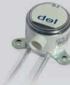
DOL 18 ist ein Unterdrucksensor, der den Druck im Stall aktiv misst. Der Sensor liefert ein 0-10 V Messsignal. Die Stromversorgung des Sensors erfolgt durch den ViperTouch.
