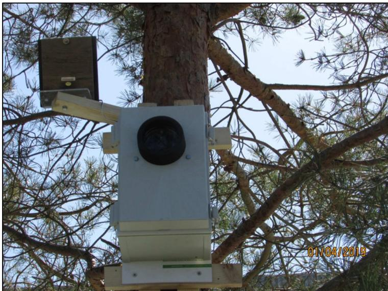
Abbildung 8-5: Dauererfassung in Kunststoffbox mit Solarpanel
