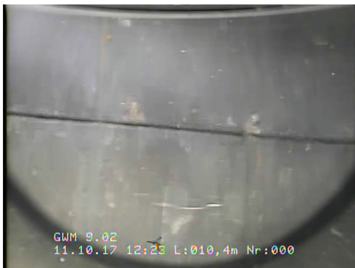
Detailaufnahme GWM 9.02 Filteroberkante bei 10,4 m (horizontale Sicht)
