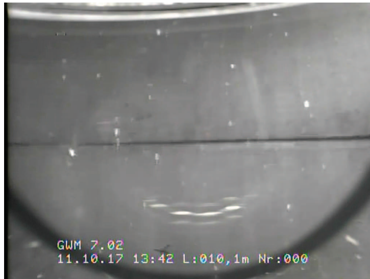
Detailaufnahme GWM 7.02 Filteroberkante bei 10,1 m (horizontale Sicht)
