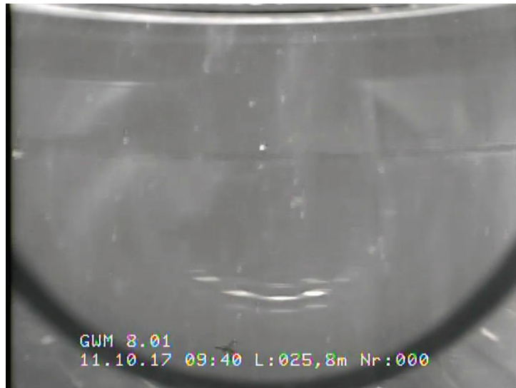
Detailaufnahme GWM 8.01 Filteroberkante bei 25,8 m (horizontale Sicht)
