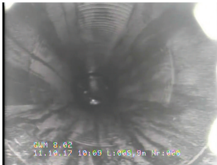
Detailaufnahme GWM 8.02 Filteroberkante bei 8,9 m (vertikale Sicht)
