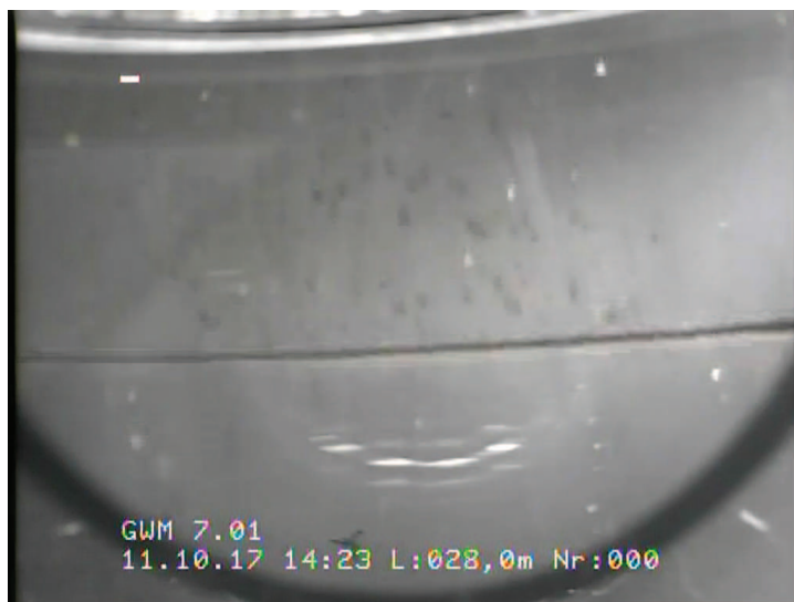
Detailaufnahme GWM 7.01 Filteroberkante bei 28,0 m (horizontale Sicht)
