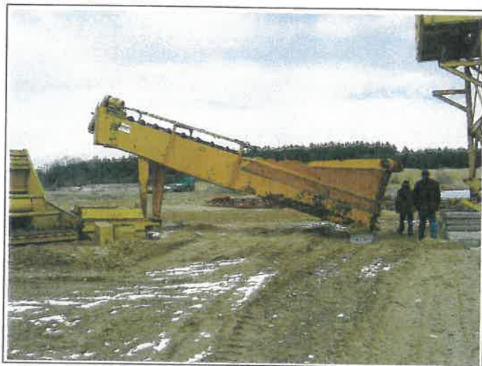
Bild 4: Sandentwässerungsschnecke (Typ EAGLE)
