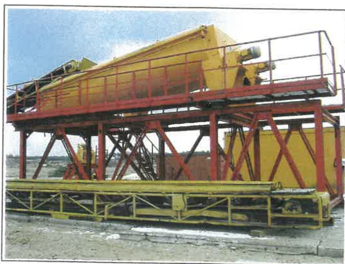
Bild 5: Schwerterwäsche mit Entwässerungsrinne (Typ SW 70)
