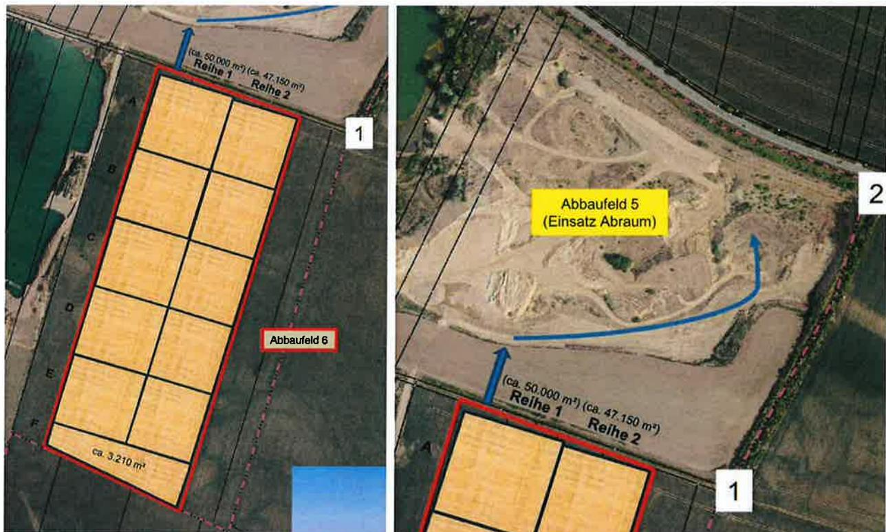
Abb. 10.1: Schema des feldweisen Abbaus im AF 6 im TS und Umlagerung des Oberbodens/Abraum in das AF 5
