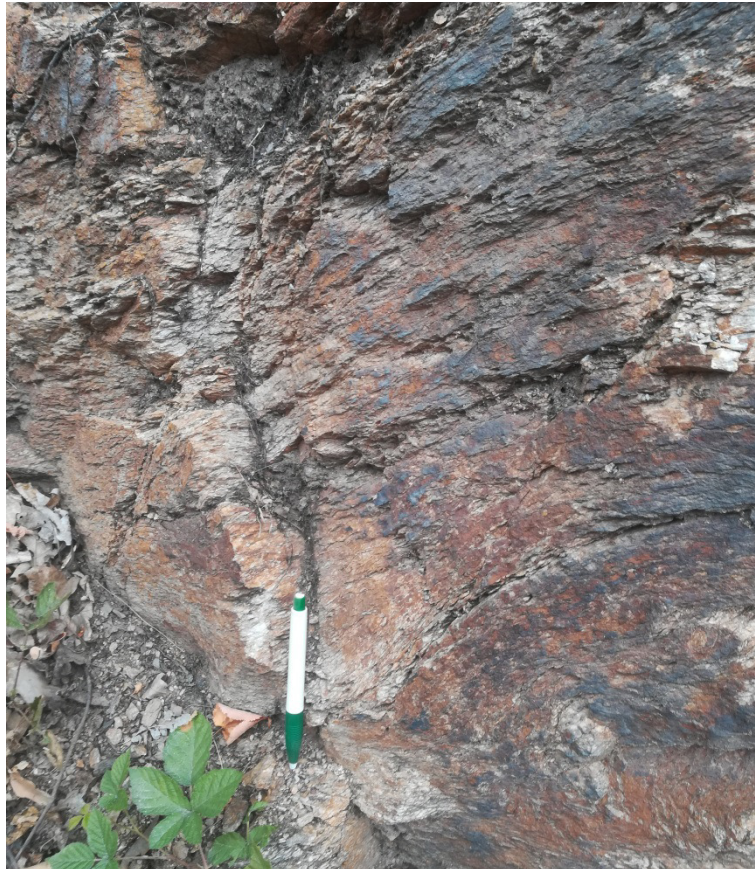
Bild 5: vollständig bis stark verwitterter Bereich C 2
