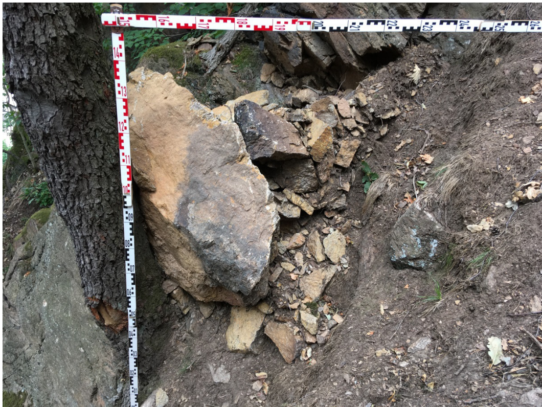
Bild 2: größter abgestürzter Block im Bereich B 4
