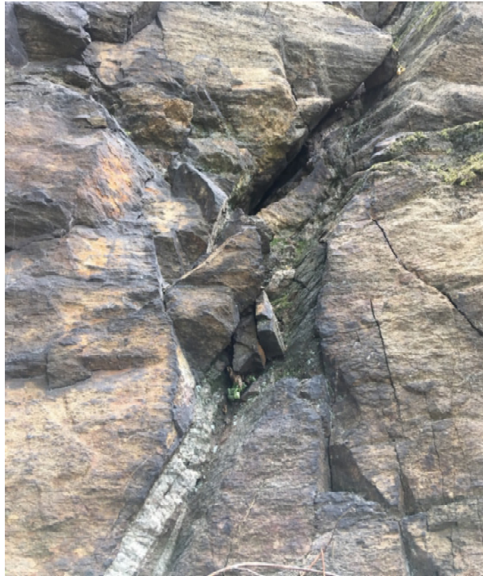
Bild 5: schräg einfallende Störung (Quarzgang) im Bereich B 6
