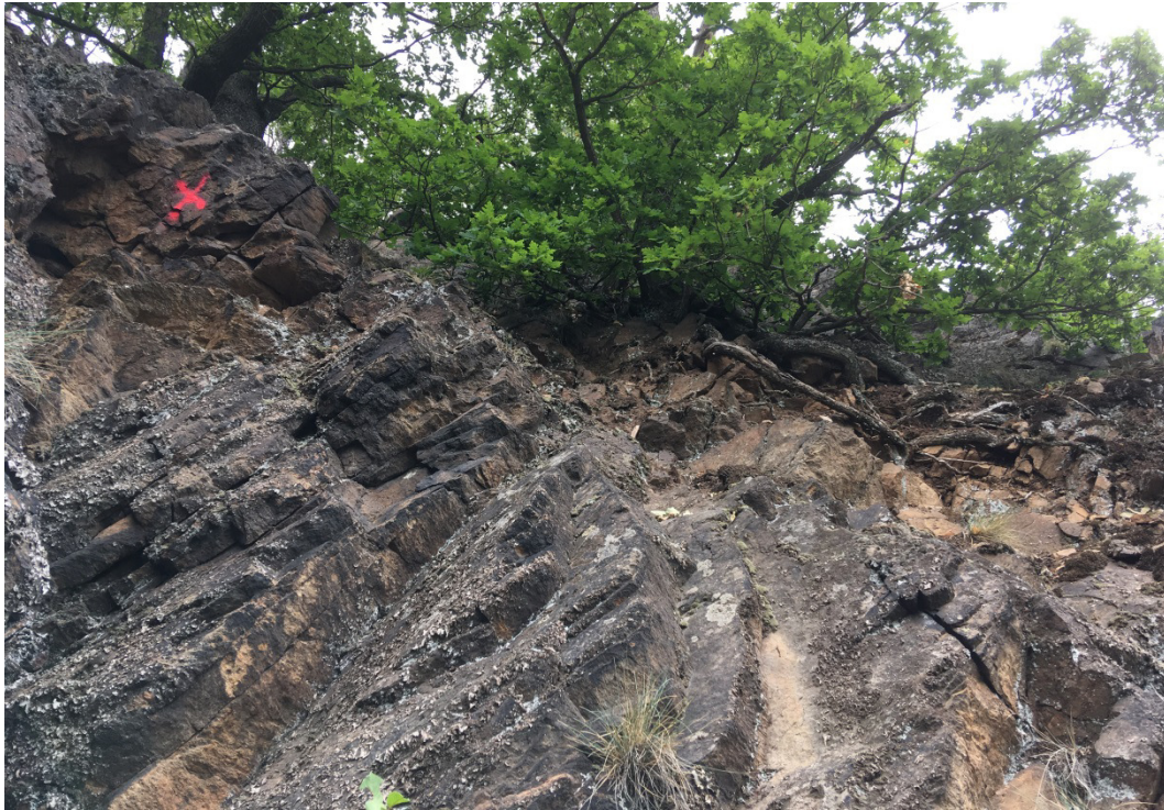
Bild 1: rechts: größter absturzgefährdeter Block, links: mäßig bis starke Auflockerung als Folge von Wurzelsprengung
