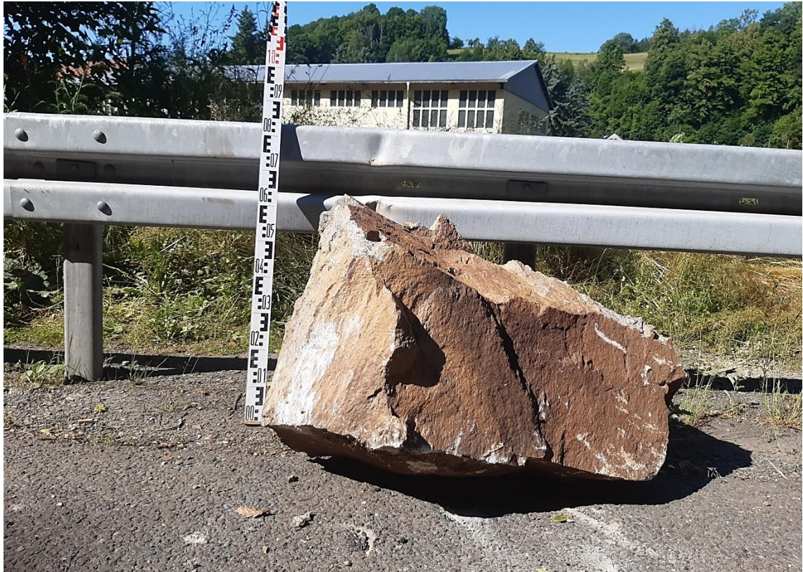
Bild 18: beräumter Kluftkörper durchschlag mobile Steinschlagschutzwand Blick nach Südwesten, 17.06.2021
