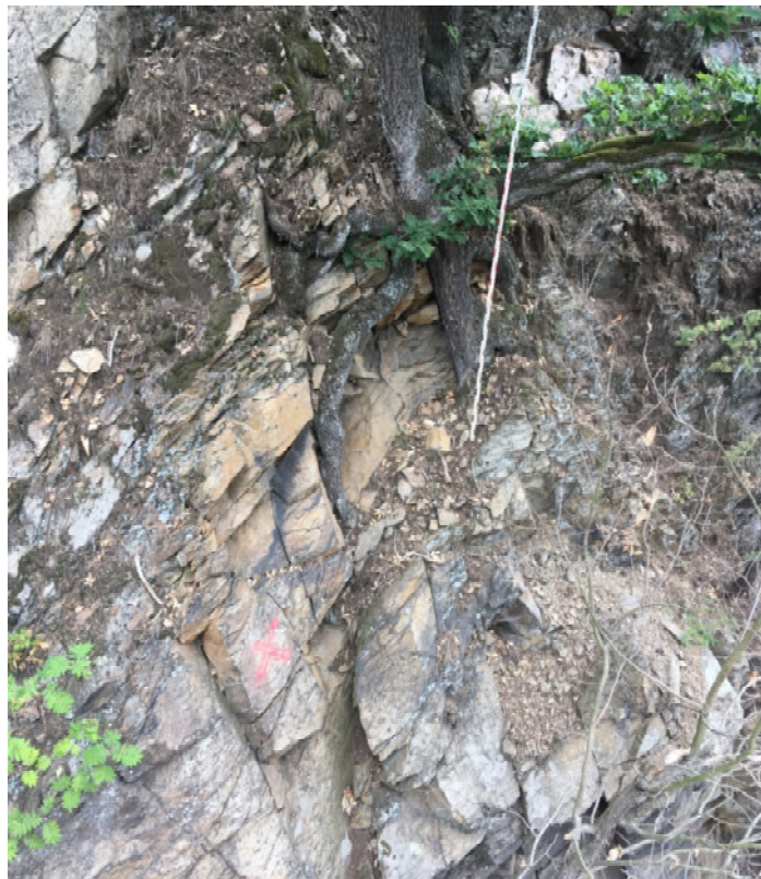
Bild 2: absturzgefährdete Blöcke im Bereich C 2
