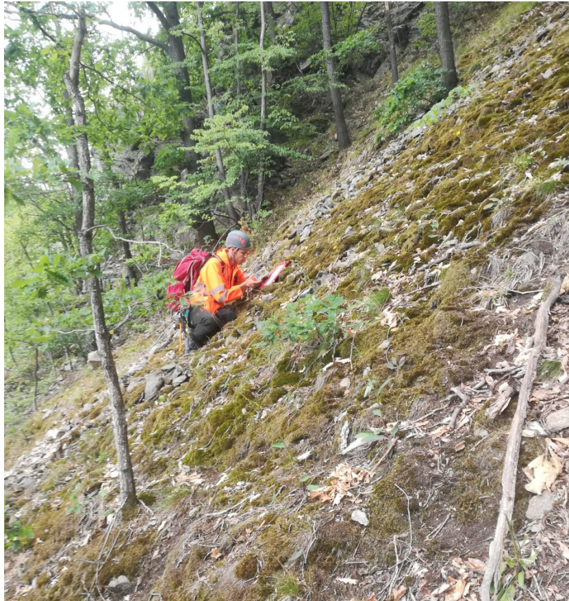
Bild 3: Aufnahme der Hangneigung im mittleren Bereich der Rinne III
