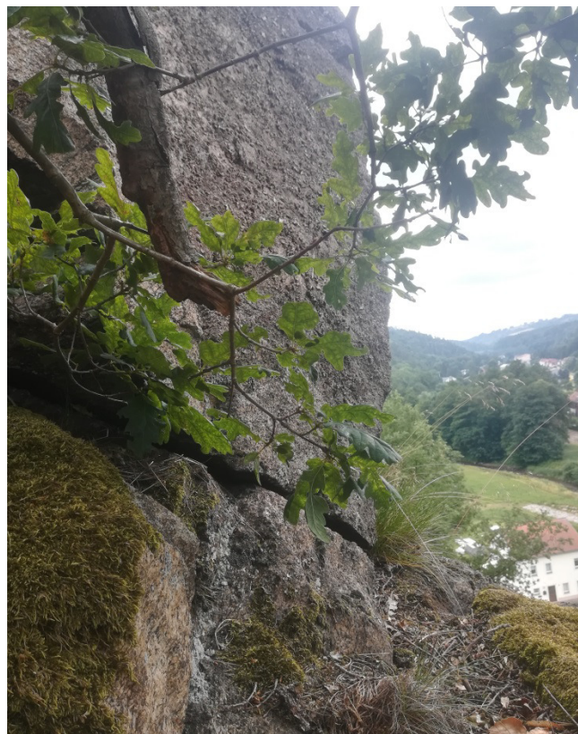
Bild 2: ca. 2 cm geöffnete, Richtung Straße geneigte Kluft unter absturzugefährdetem Block
