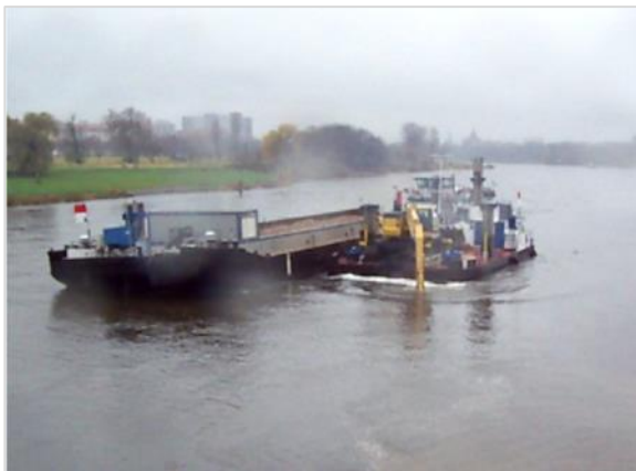
Abb. 79: Ponton mit Hydraulikbagger und Schubverband im Einsatz (Quelle: StowasserPlan 2011, Foto 2, S. 4)
