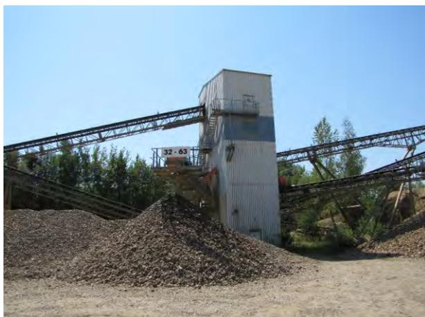
Abbildung 11: Kieswerk, Vorsiebanlage mit Brecher
