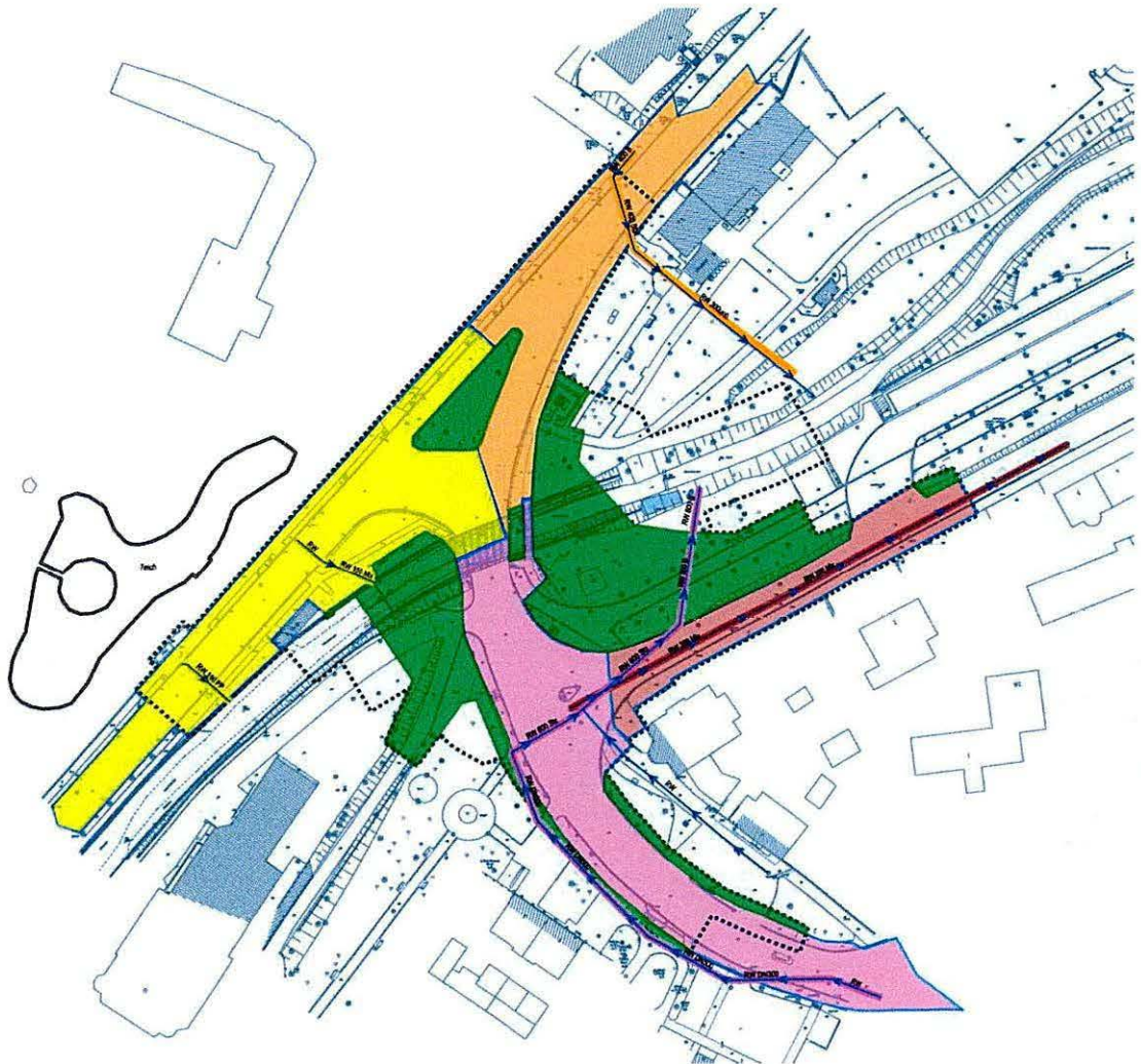
Abbildung 1: bestehende Entwässerungsflächen (siehe auch U 18.1, Anl. 2)
