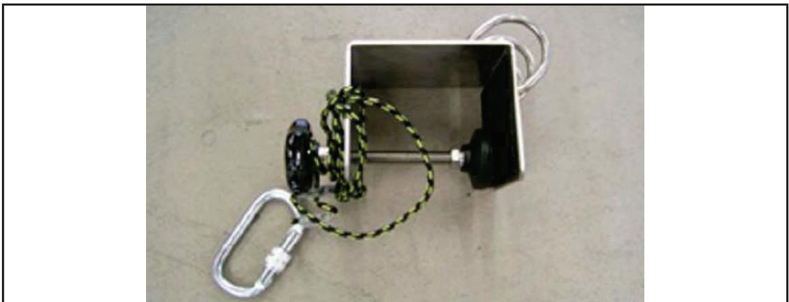
Abb. 26: U-förmiger Kantenschutz
