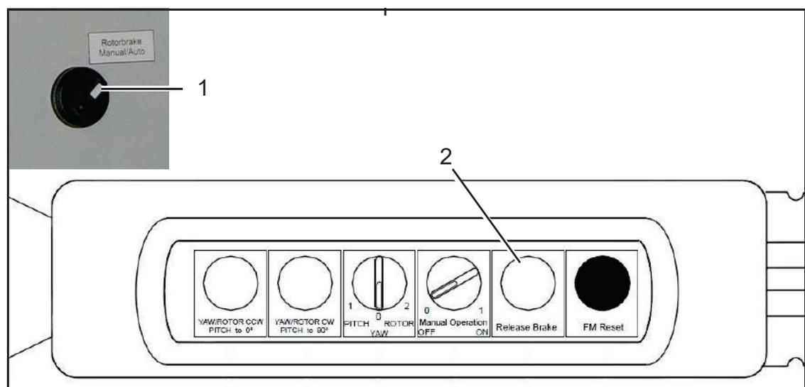
Abb. 23: Bedienelemente für manuellen Betrieb der Rotorbremse
