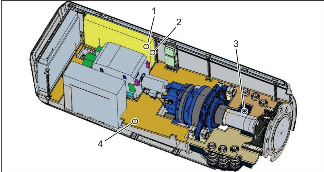
Abb. 16: Not-Halt-Schalter und Ausschalter Mittelspannung im Maschinenhaus (Abb. ähnlich)
