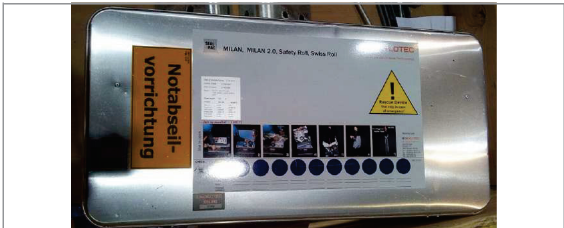
Abb. 3: Notabseilrüstung in der WEA
