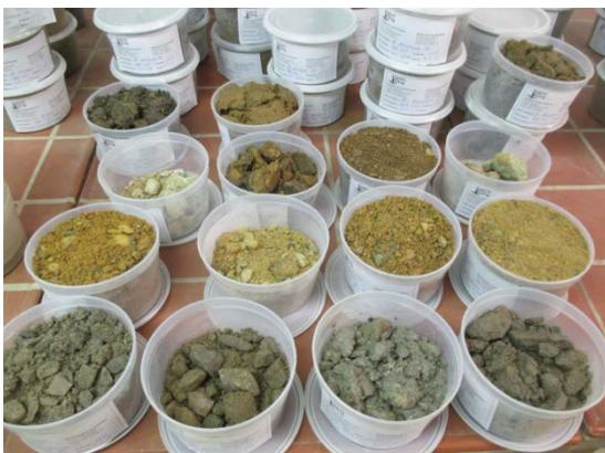
Bild 11: Probenkontrolle/ Mischprobenbildung
