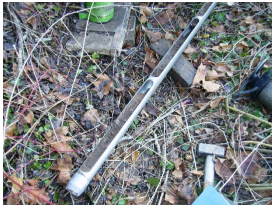
Bild 8: Hohlsonde mit Bodenmaterial (KRB 332)
