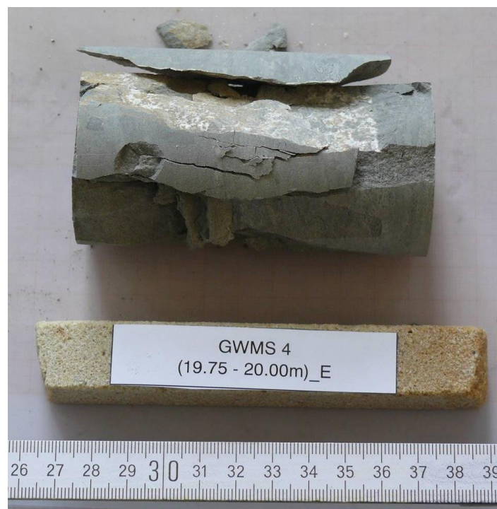
Abb. 10: GWMS 4 (19.75-20.00m)_E, Einaxialer Druckversuch, Bruchbild, Spaltbruch überwiegend
