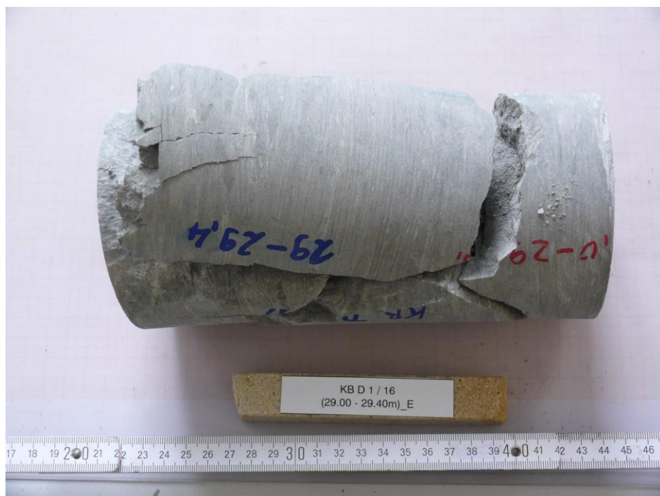
Abb. 8: KB D 1/16 (29.00-29.40m)_E, Einaxialer Druckversuch, Bruchbild, Mischbruch (Spalt- & Scherbruch)
