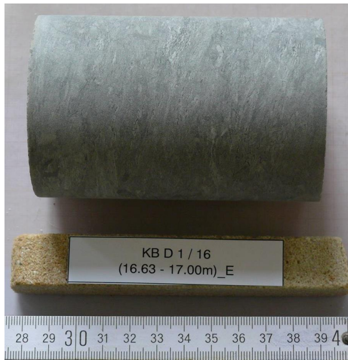
Abb. 1: KB D 1/16 (16.63-17.00m)_E, Prüfkörper vor dem Versuch
