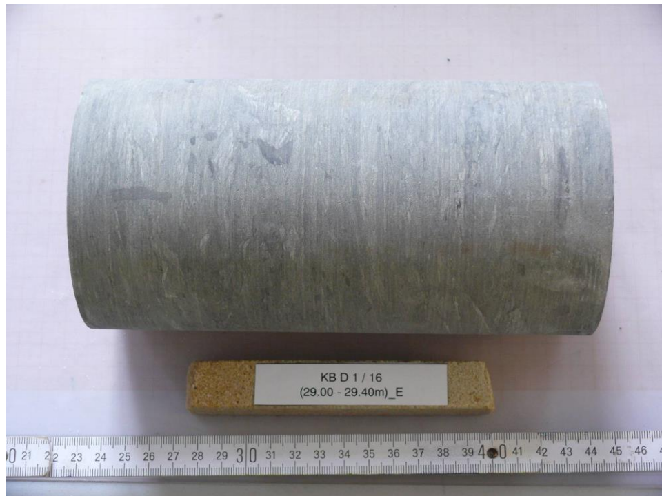
Abb. 7: KB D 1/16 (29.00-29.40m)_E, Prüfkörper vor dem Versuch
