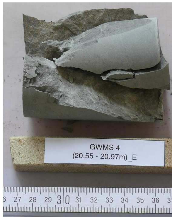
Abb. 12: GWMS 4 (20.55-20.93m)_E, Einaxialer Druckversuch, Bruchbild, Scherbruch
