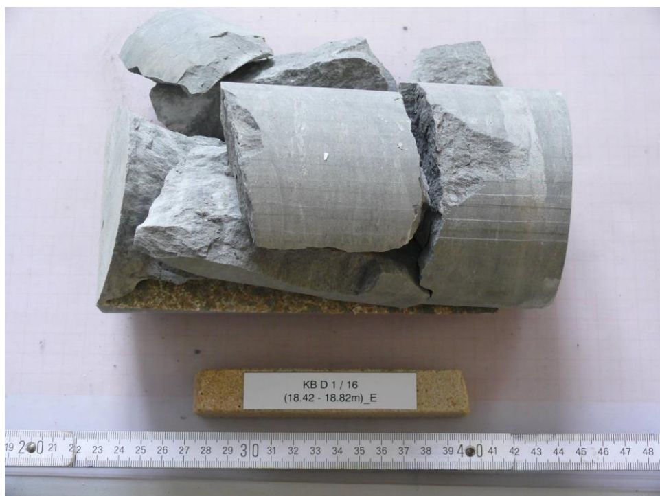
Abb. 4: KB D 1/16 (18.42-18.82m)_E, Einaxialer Druckversuch, Bruchbild, Spaltbruch an vorhandener, achsparalleler Kluft
