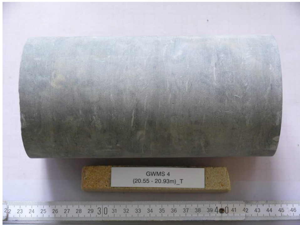
Abb. 21: GWMS 4 (20.55-20.93m)_T, Prüfkörper vor dem Versuch
