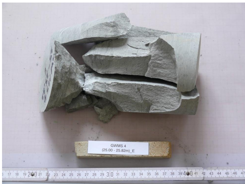
Abb. 16: GWMS 4 (25.00-25.82m)_E, Einaxialer Druckversuch, Bruchbild, , Mischbruch (Spalt- & Scherbruch)
