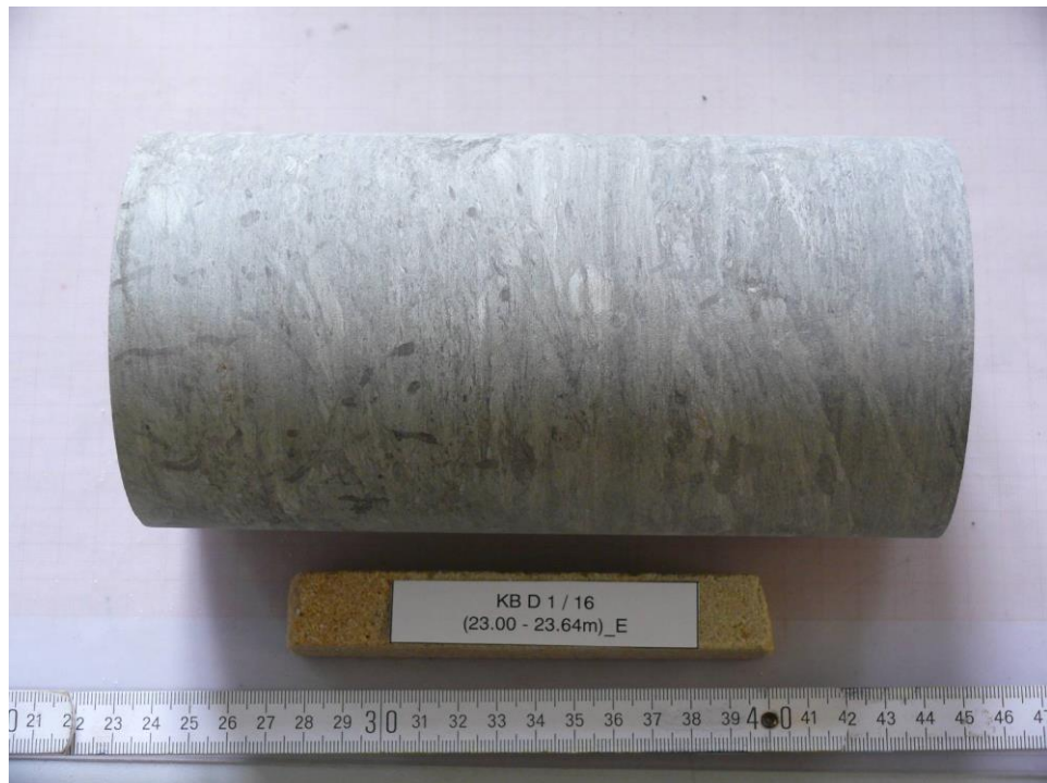
Abb. 5: KB D 1/16 (23.00-23.64m)_E, Prüfkörper vor dem Versuch
