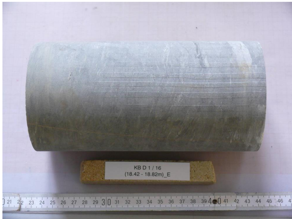
Abb. 3: KB D 1/16 (18.42-18.82m)_E, Prüfkörper vor dem Versuch
