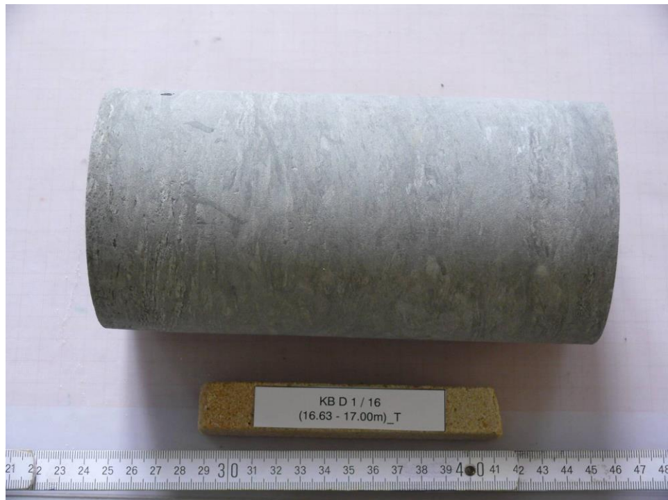
Abb. 17: KB D 1/16 (16.63-17.00m)_T, Prüfkörper vor dem Versuch
