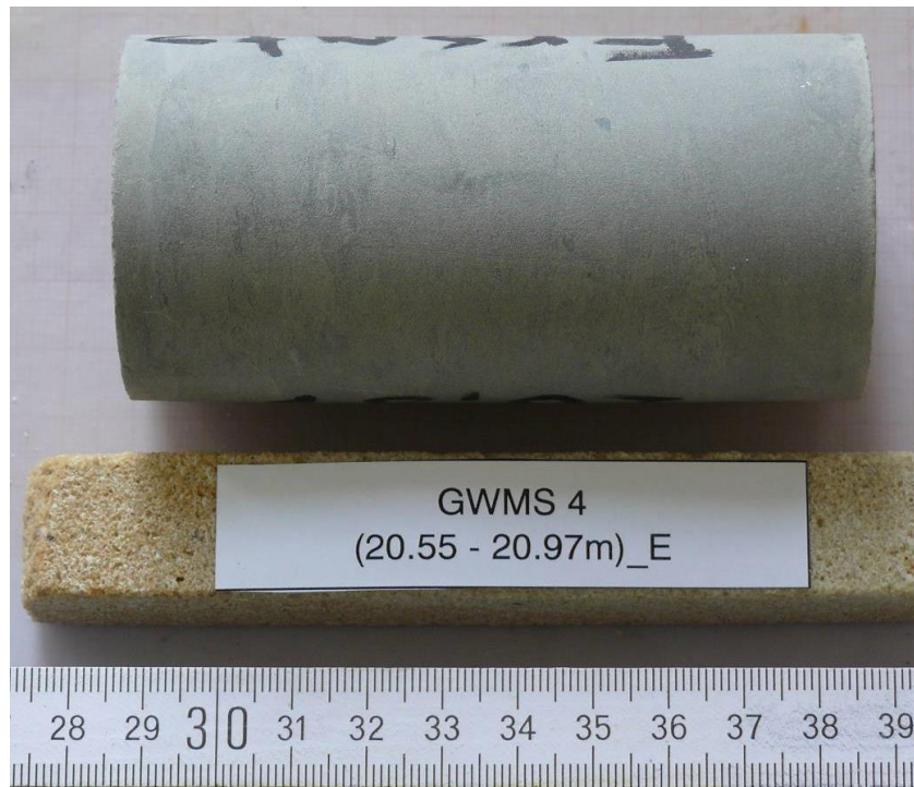
Abb. 11: GWMS 4 (20.55-20.93m)_E, Prüfkörper vor dem Versuch
