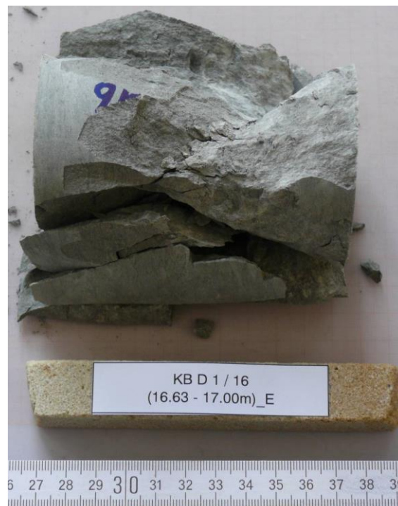
Abb. 2: KB D 1/16 (16.63-17.00m)_E, Einaxialer Druckversuch, Bruchbild, Scherbruch
