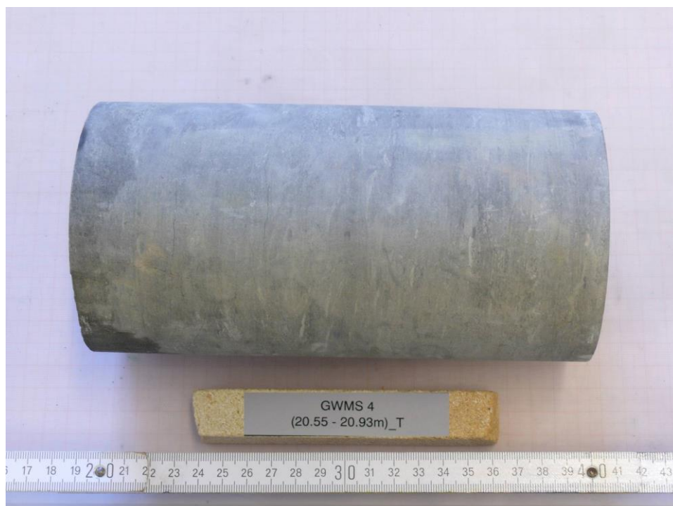
Abb. 22: GWMS 4 (20.55-20.93m)_T, Triaxialer Druckversuch, Bruchbild
