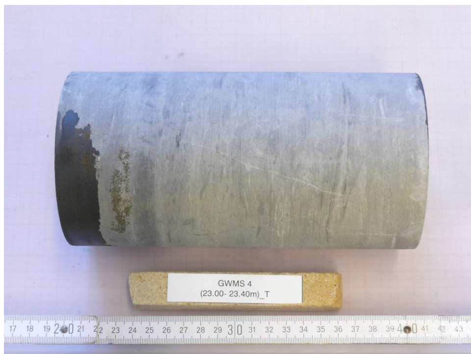
Abb. 24: GWMS 4 (23.00-23.40m)_T, Triaxialer Druckversuch, Bruchbild
