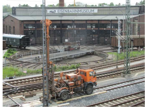
Bild 1 und Bild 2 In einem frisch umgebauten, von Fahrleitungsleitungen noch freien Bahngleis hergestellte schwere Rammsondierung DPH B229 und Kernbohrung KB B229.
