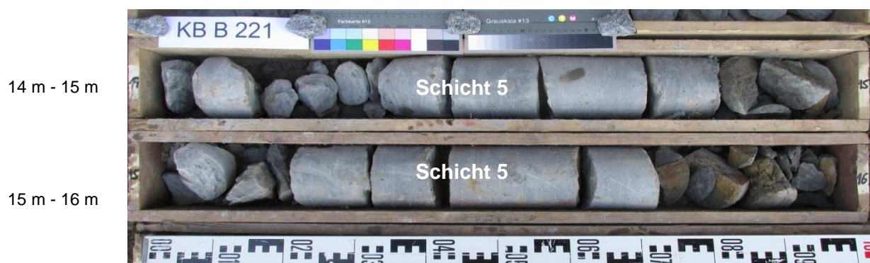
Bild 15 Bohrkernfotos der Kernbohrung KB B221 aus 8 m bis 16 m Tiefe mit Kennzeichnung der Schichten 4a, 4b und 5.
