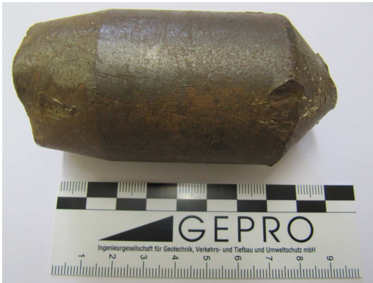
Bild 10 Verformte Rammspitze von DPH B230.
