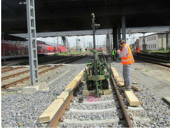
Bild 1 und Bild 2 In einem frisch umgebauten, von Fahrleitungsleitungen noch freien Bahngleis hergestellte schwere Rammsondierung DPH B229 und Kernbohrung KB B229.
