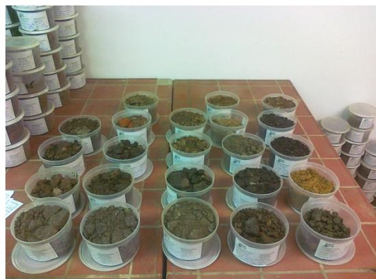
Bild 12: Begutachtung der Einzelproben und Mischprobenbildung für die Deklarationsproben
