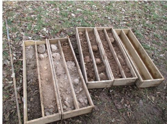
Bild 8: Auslage des Bohrgutes in Kernkisten B 104 – vor Ort
