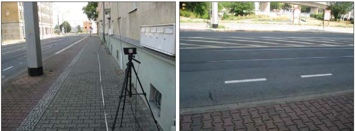
Abb. 5 Lichtschranken zur Geschwindigkeitsmessung, Fahrbahn vor dem untersuchten Gebäude
