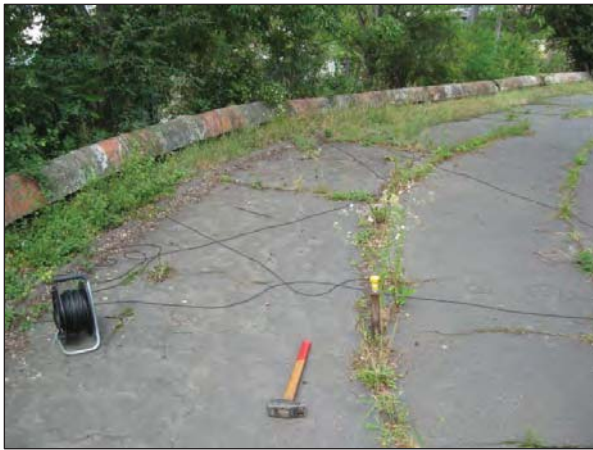
Abb. 8 Messaufnehmer in 17 m Abstand zum nächstgelegenen Gleis (MP 2z Boden); Erdspeiß nicht in ausreichender Tiefe einbringbar
