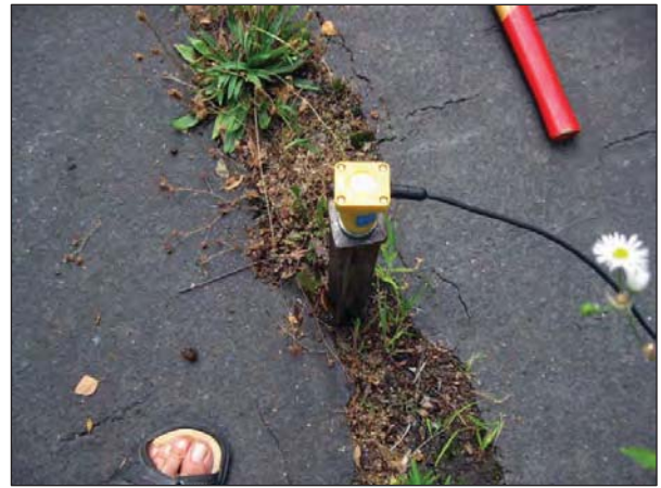
Abb. 8 Messaufnehmer in 17 m Abstand zum nächstgelegenen Gleis (MP 2z Boden); Erdspeiß nicht in ausreichender Tiefe einbringbar
