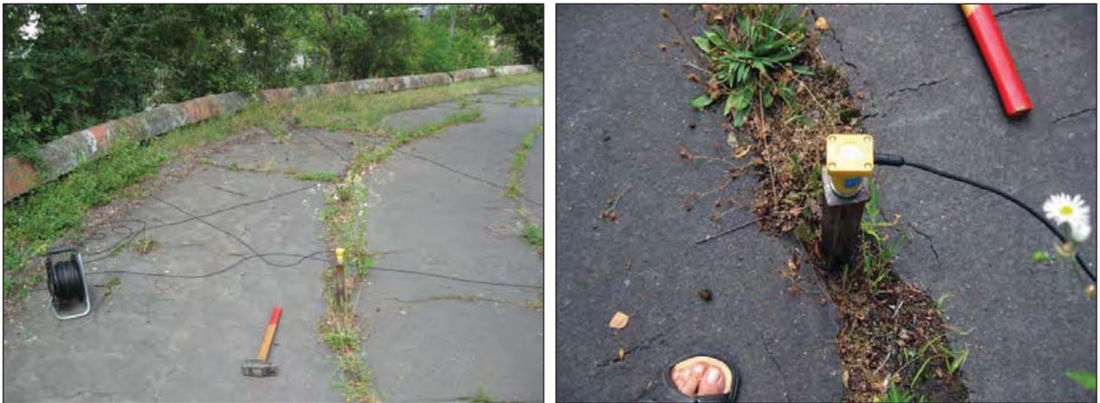
Abb. 8 Messaufnehmer in 17 m Abstand zum nächstgelegenen Gleis (MP 2z Boden); Erdspieß nicht in ausreichender Tiefe einbringbar
