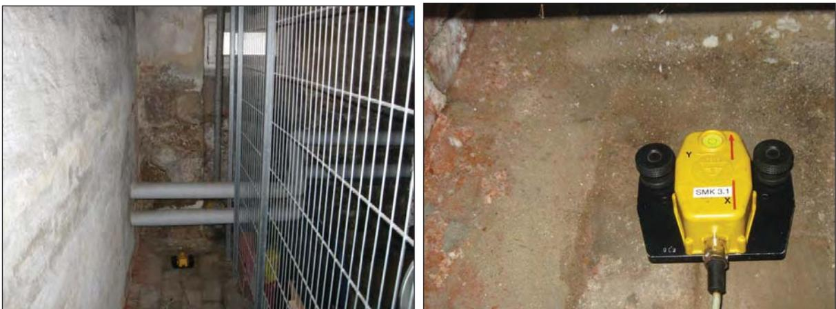
Abb. 2 Messaufnehmer am Gebäudefundament (Keller straßenseitig, MP 1 x/y/z Gebäude)
