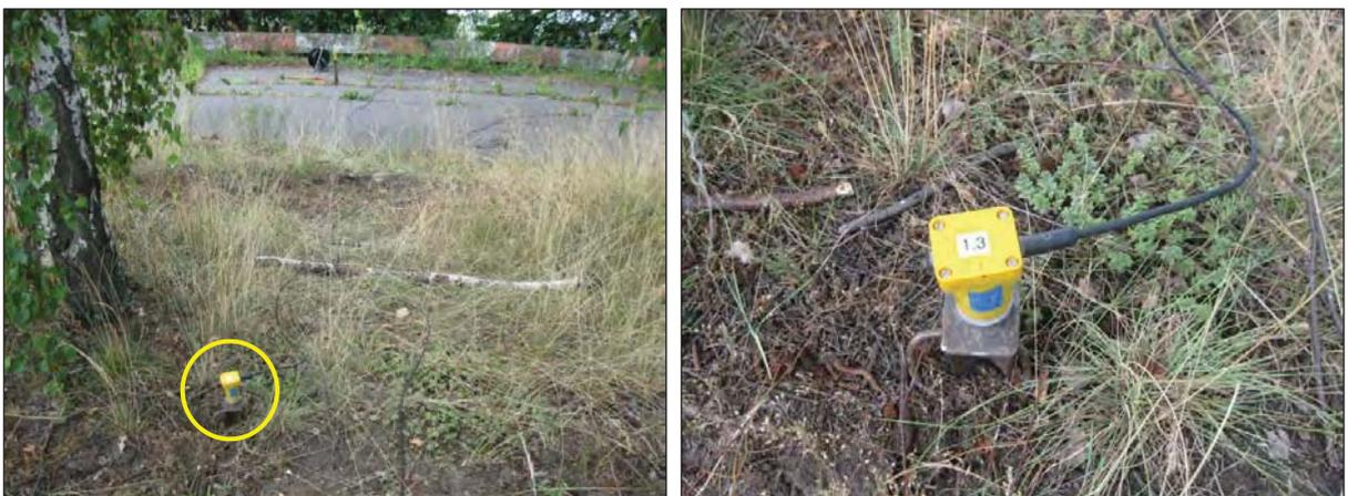
Abb. 9 Messaufnehmer in 25 m Abstand zum nächstgelegenen Gleis (MP 3z Boden)
