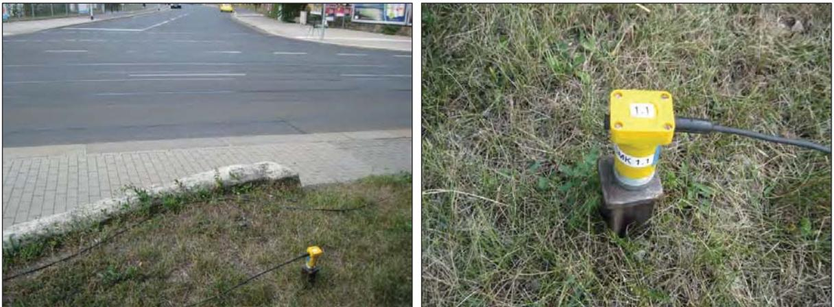
Abb. 7 Messaufnehmer 8 m Abstand zum nächstgelegenen Gleis (MP 1z Boden)
