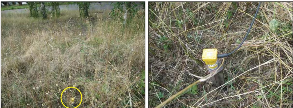
Abb. 10 Messaufnehmer in 33 m Abstand zum nächstgelegenen Gleis (MP 4z Boden)
