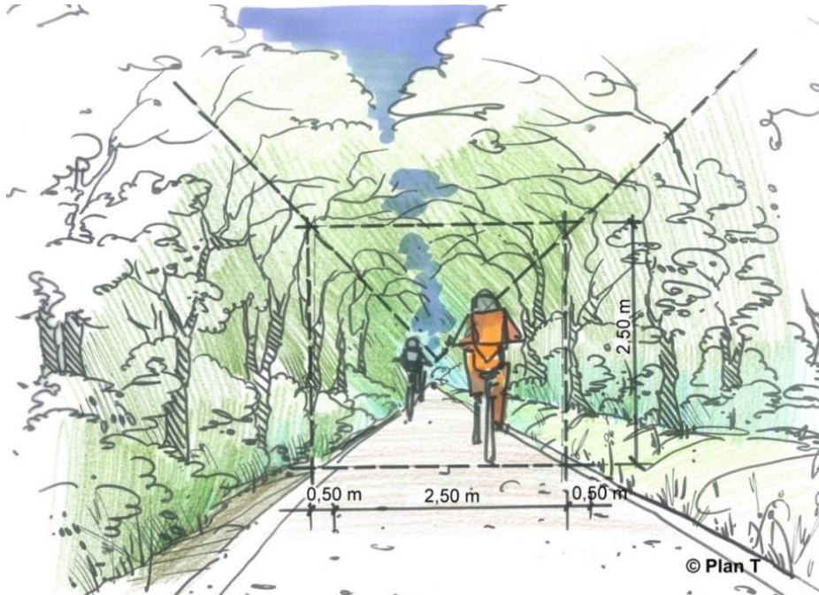
Abbildung 33: Prinzipiskezze des empfohlenen Regelquerschnitts von Radwegen auf ehemaligen Bahntrassen
