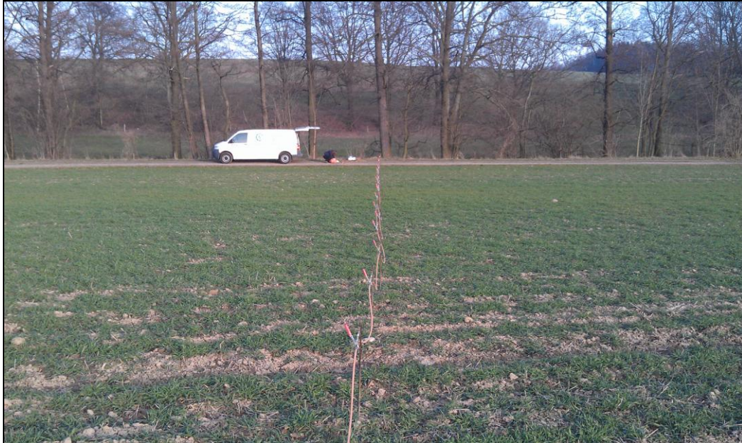
Foto 5: 2D-tomographische widerstandsgoelektrische Messung
