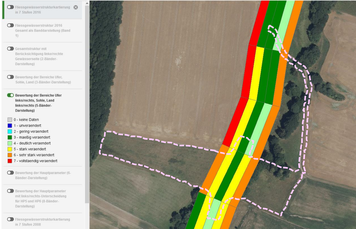
Abb. 37: 5-stufige Strukturkartierung 2016 87 „Land-Ufer-Sohle-Ufer-Land“ für den Bereich HRB II (neu)/ Vorzugslösung: Ufer links: sehr stark verändert, Sohle: überwiegend mäßig verändert, in Teilen deutlich verändert, Ufer rechts: überwiegend sehr stark verändert, in Teilen deutlich verändert
