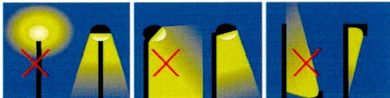
Abbildung 1: Maßnahmen zur punktuellen Beleuchtung von Baustellen (aus Schmid et. al 2012) (die rechten Darstellungen entsprechen den Empfehlungen.)
