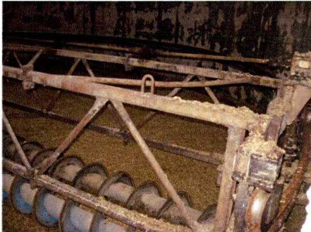
Abbildung 2: Verteil- und Entnahmemaschine (VES)
