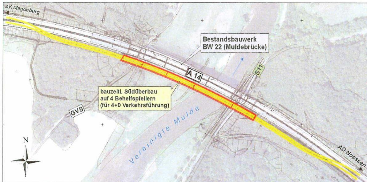
Abbildung 1.3-2: Lageskizze des bauzeitlichen Südüberbaus Bauvariante 2a bis 2c
