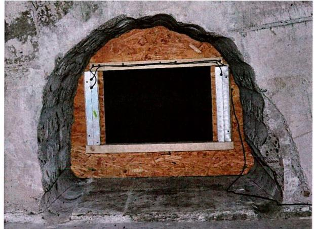
Abb. 6: Montage der Lichtschranke am Durchbruch zwischen oberer und unterer Ebene (LISA A)
