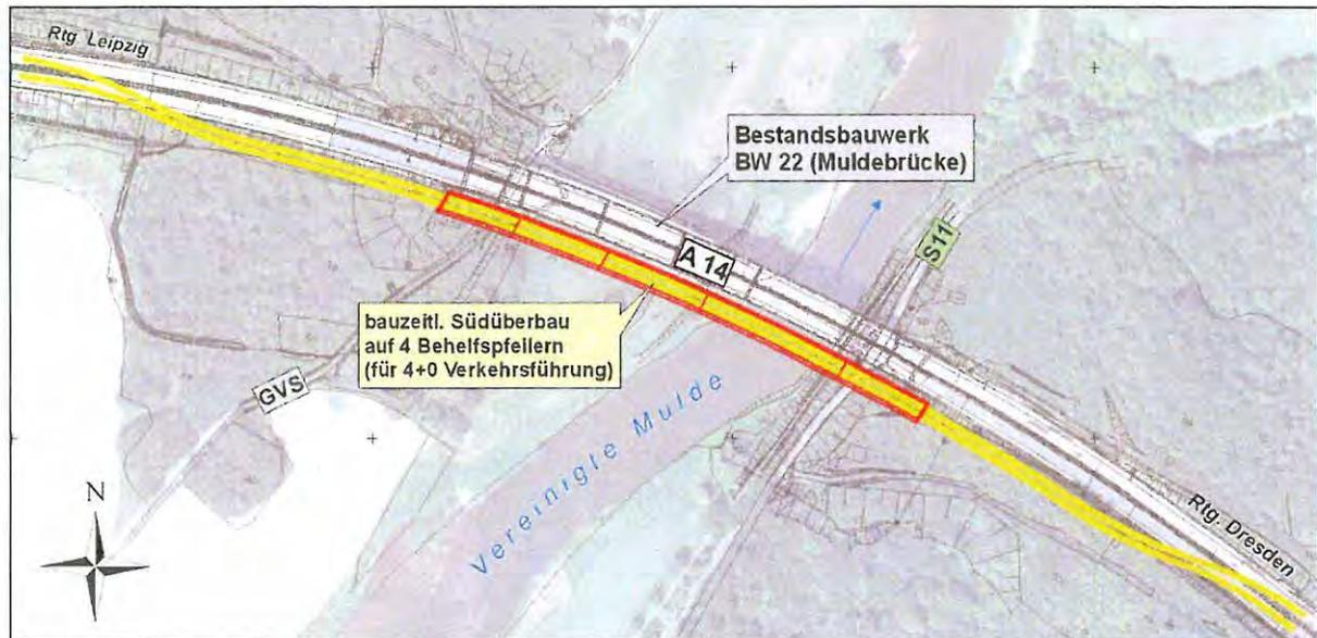
Abbildung 6: Lageskizze des bauzeitlichen Südüberbaus Bauvariante 2c mit 4+0 Verkehrsführung
