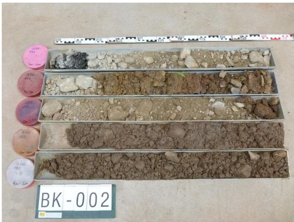
Foto 7: Bohrgut BK 2 von 0,0 bis 5,0 m u. OK Straße
