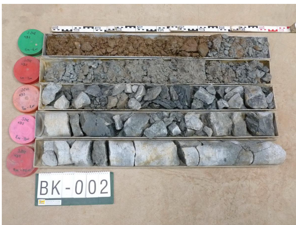
Foto 8: Bohrgut BK 2 von 5,0 bis 10,0 m u. OK Straße
