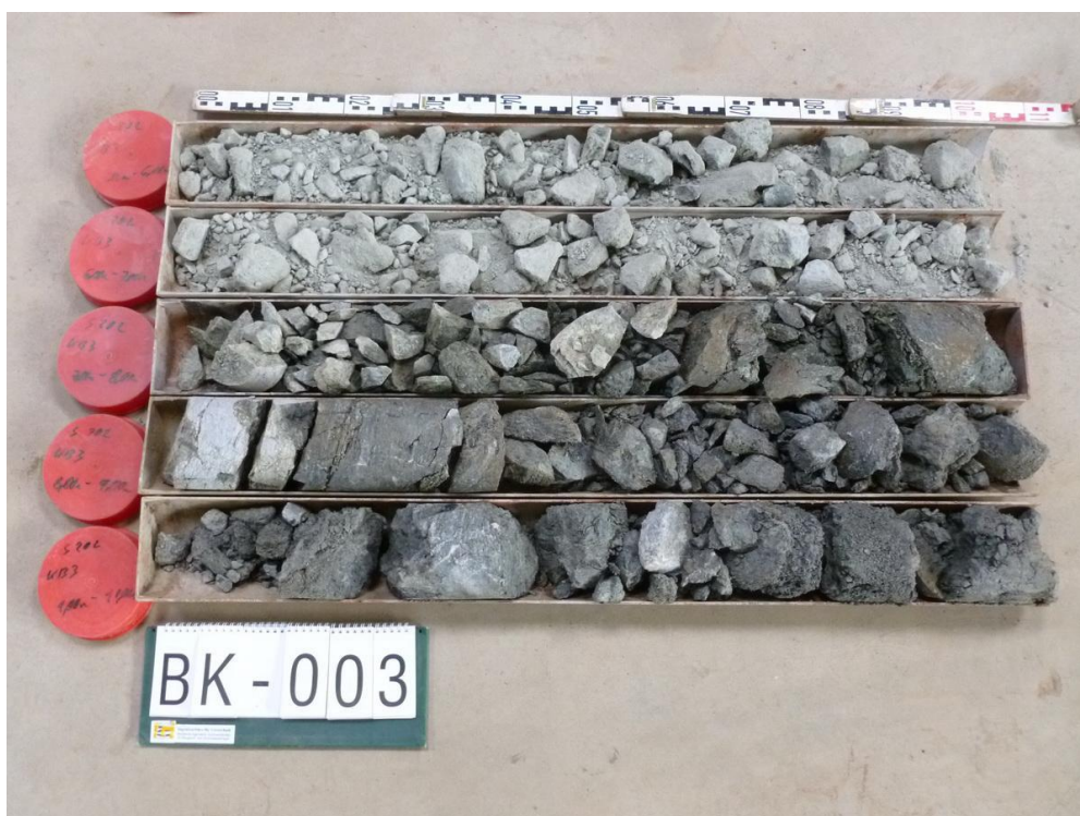
Foto 10: Bohrgut BK 3 von 5,0 bis 10,0 m u. OK Straße
