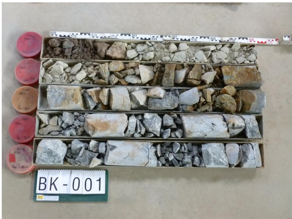
Foto 6: Bohrgut BK 1 von 5,0 bis 10,0 m u. OK Straße
