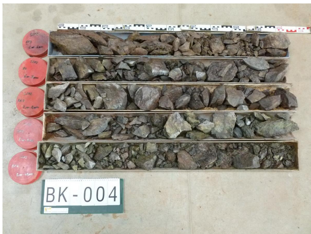
Foto 12: Bohrgut BK 4 von 5,0 bis 10,0 m u. OK Straße
