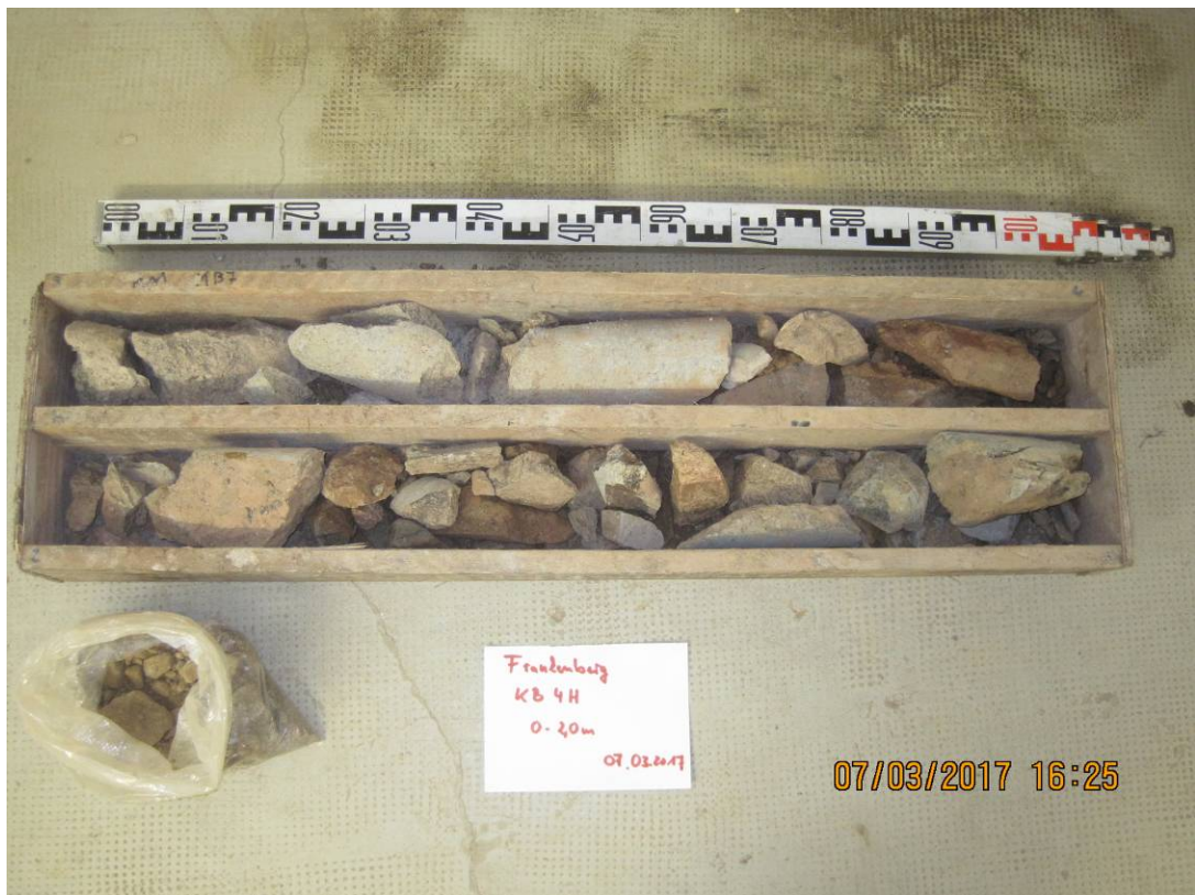
Foto 08: Bohrung KB 4H, Bohrkern
