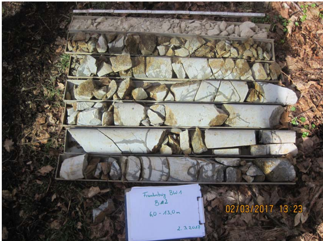
Foto 04: Bohrung B 2, Bohrkern 6 – 13 m
