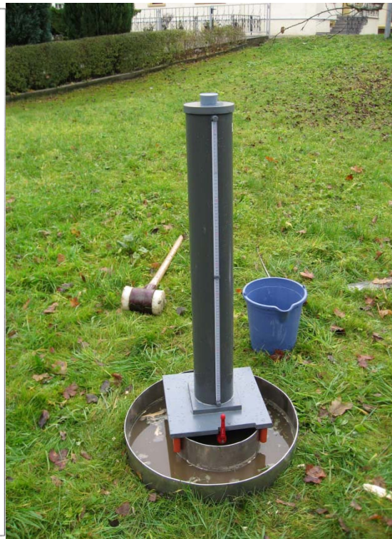
Abb. 3: Doppelring-Infiltrrometer
