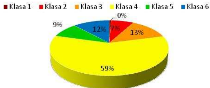
Bild 4-9 Anteile der Pasquill-Atmosphären-Gleichgewichtsklassen, die durch das WRF/CALMET-Modell im Auge des der Lage des Kraftwerk Turów entsprechenden meteorologischen Netzes im Jahr 2012 bestimmt wurden
