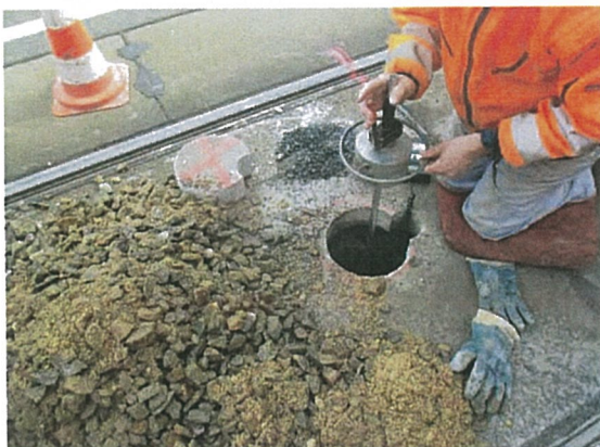
Bild 1: Ausführung der dyn LP im Gleiskörper KRB1 (Schurf)
