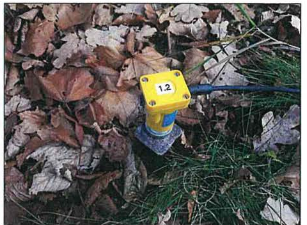
Abb. 3 Messaufnehmer in 14 m Abstand zum nächstgelegenen Gleis (MP 2z Boden)
