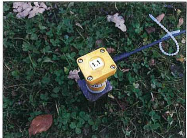
Abb. 2 Messaufnehmer 8 m Abstand zum nächstgelegenen Gleis (MP 1z Boden)
