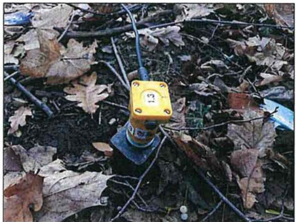
Abb. 4 Messaufnehmer in 20 m Abstand zum nächstgelegenen Gleis (MP 3z Boden)
