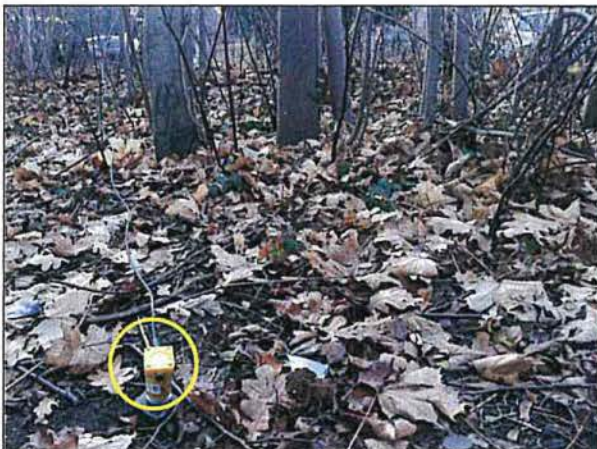
Abb. 4 Messaufnehmer in 20 m Abstand zum nächstgelegenen Gleis (MP 3z Boden)
