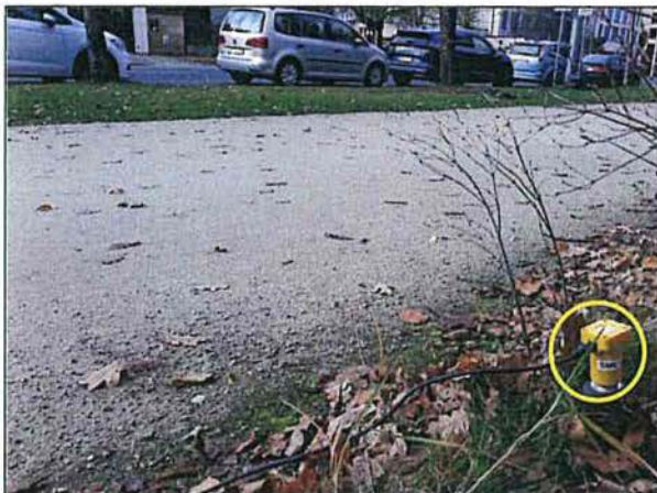
Abb. 3 Messaufnehmer in 14 m Abstand zum nächstgelegenen Gleis (MP 2z Boden)
