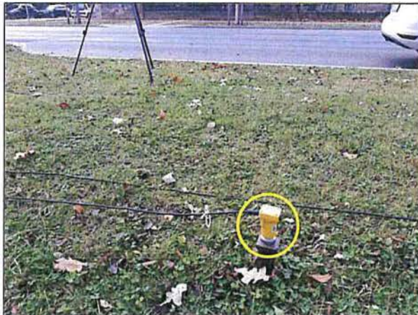
Abb. 2 Messaufnehmer 8 m Abstand zum nächstgelegenen Gleis (MP 1z Boden)
