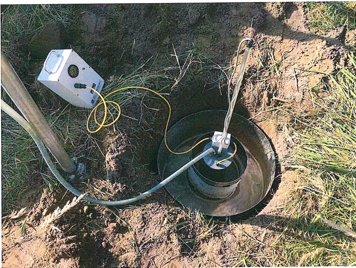
Abbildung 1 Doppelringinfiltrometer mit Innen- und Außenring, Füllstandssensor und Energieversorgung
